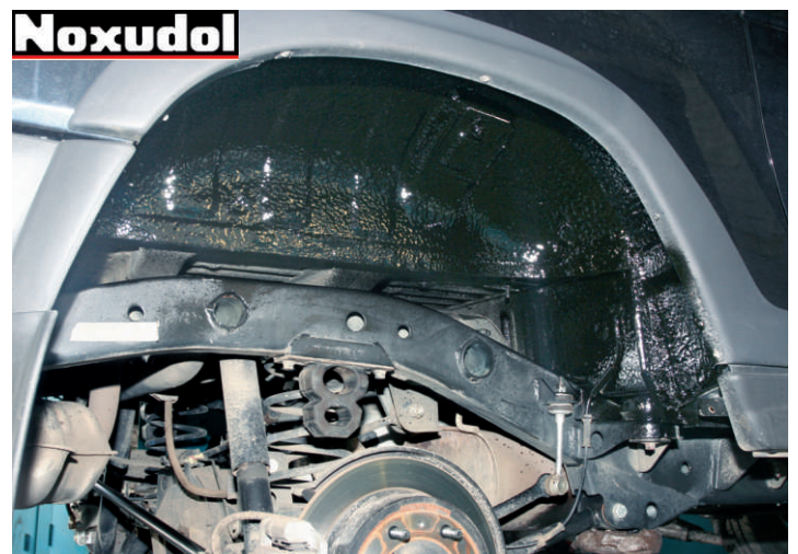
Покрyтие Noxudol Autoplaston. Распыление воздушным способом
