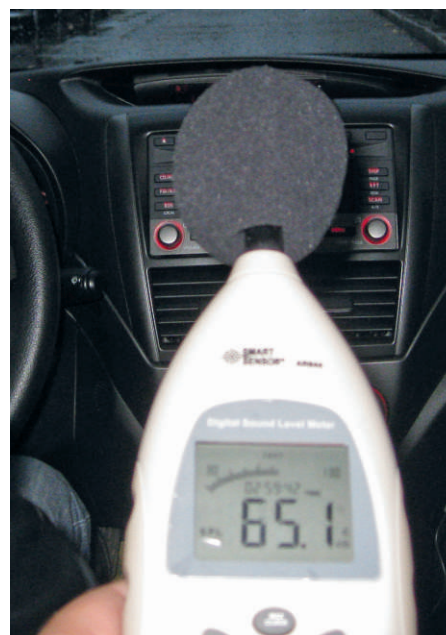
Индикация измерений в процессе дорожных испытаний
