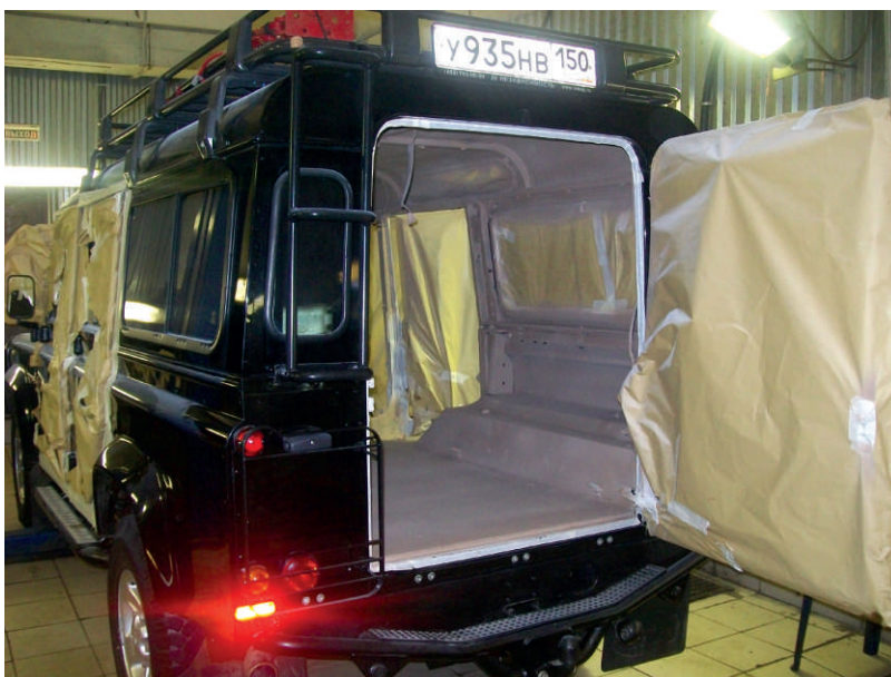
Пример обработки кузова напыляемой протившумной мастикой
