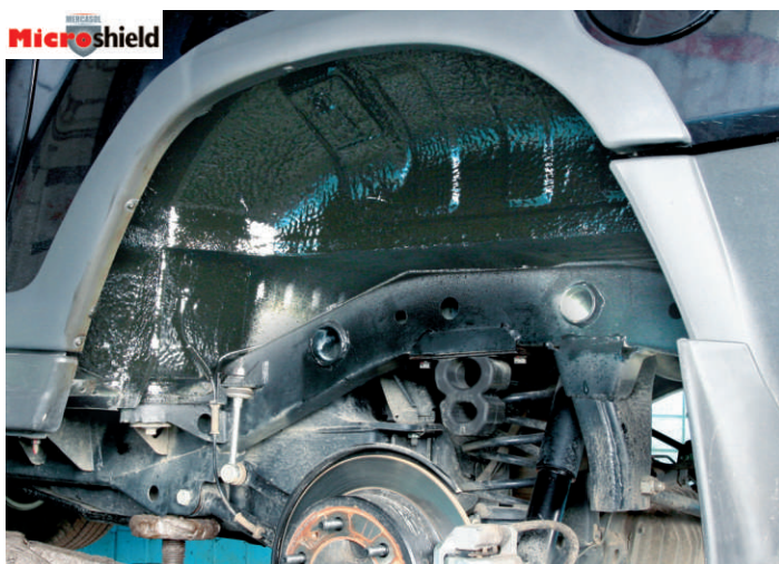
Пленка Mercasol 4, нанесенная шпателем и покрытая сверху распыляемым составом
