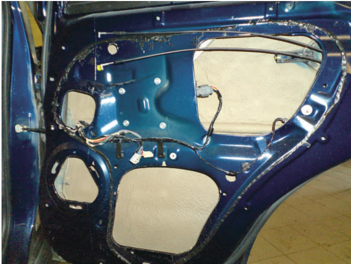
Защита наносилась на внутренние поверхности дверных панелей...
