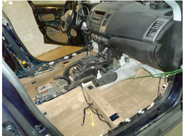
...а также на пол и короба кузова, для чего потребовалась разборка салона
