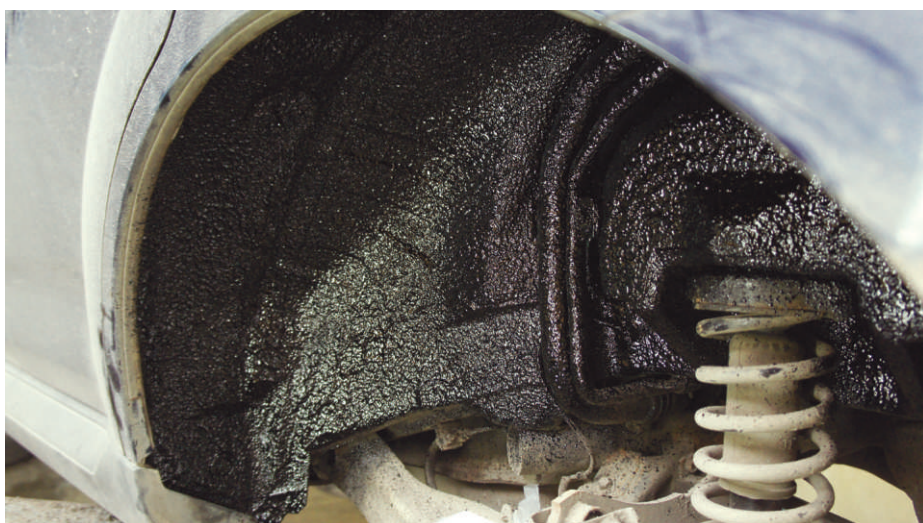
Та же арка после нанесения Mercasol Sound Stop. Можно устанавливать подкрылок
