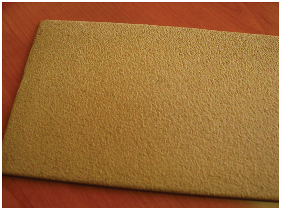
Так выглядит протившумная напыляемая пленка Noxudol 3100
