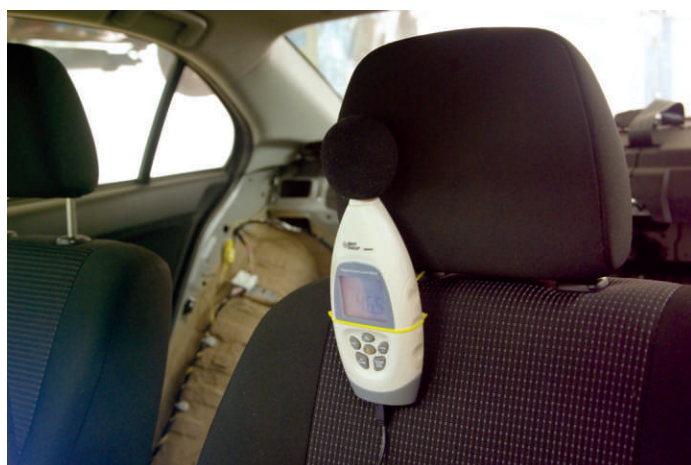
Шумомер закрепили на уровне головы водителя
