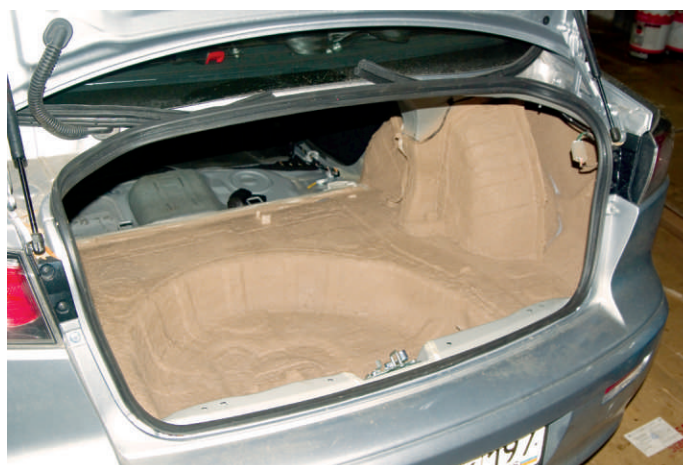
Пример обработки материалом Noxudol 3100 пола багажника в процессе эксперимента
